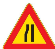
1/385 Strettoia asimmetrica a sinistra
