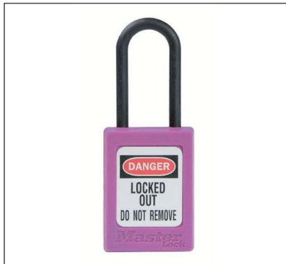
LUS32 Corpo piccolo, amagnetico, realizzato interamente in Zenex. Archetto Ø 4,76 mm., lunghezza 38 mm. Non dotato di sistema ritenzione chiave.
