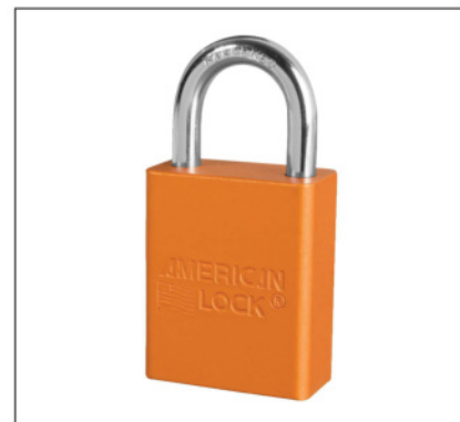
LUS1105 Corpo in alluminio anodizzato. Archetto in lega di boro placcato cromo Ø 6 mm., altezza 25 mm. Consigliato per industria alimentare.
