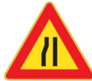
1/385 Strettoia asimmetrica a sinistra
